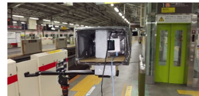
電波吸収体を適用したUE收容筐体に覆われたUEを設置
