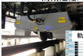
軌道材料、変位モニタリング
