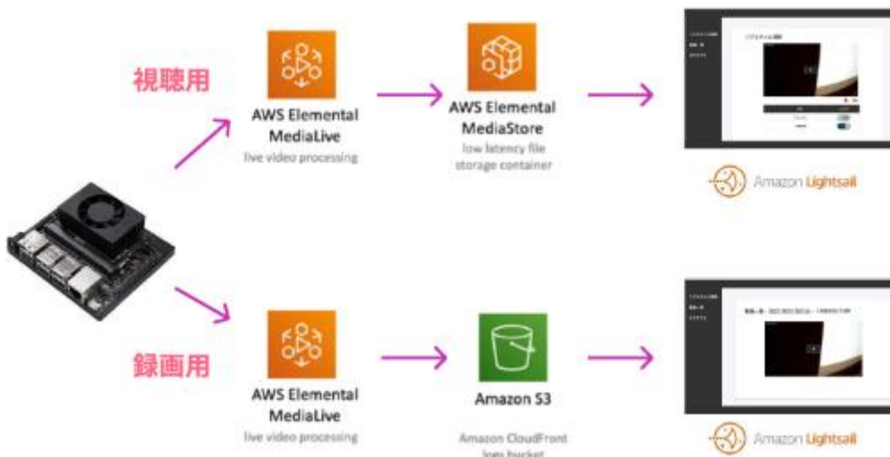
図 4.2.3-10) 「遠隔作業支援」におけるクラウド(AWS)のシステム構成
