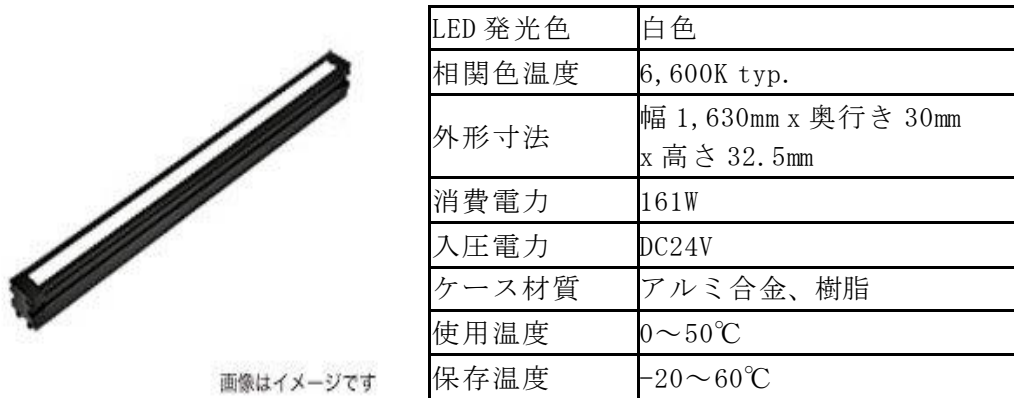
図 4.1.3-10) 画像処理照明の外観および仕様
