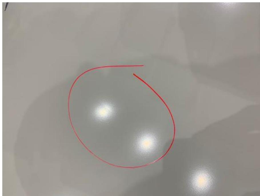
図 4.2.5-2) カラー鋼板の打痕キズ箇所 (4K 映像)
