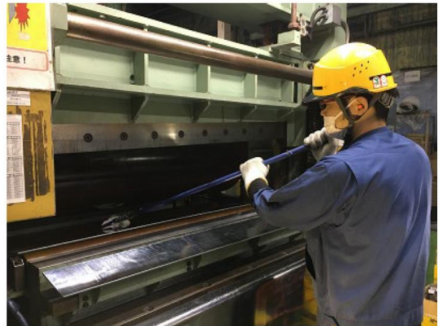
図 4. 1. 3-29) 新しいエクステンションロール清掃作業
