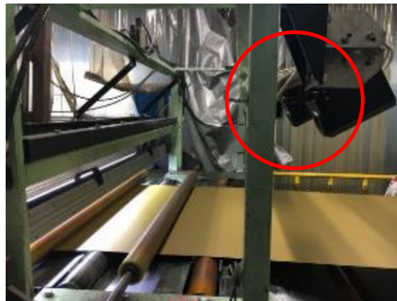
図 4.1.5-15) 既存の検査装置
