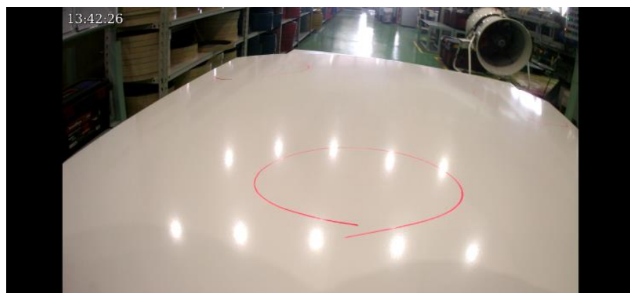
図 4.2.5-3) カラー鋼板の打痕キズ箇所 (iPhone)
