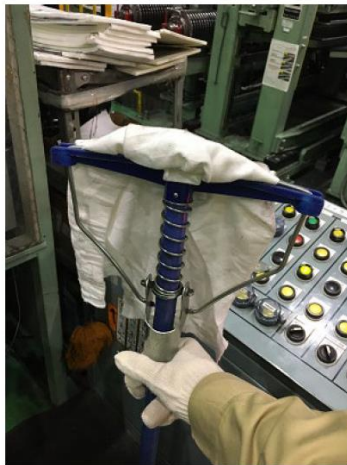
図 4. 1. 3-29) 新しいエクステンションロール清掃作業
