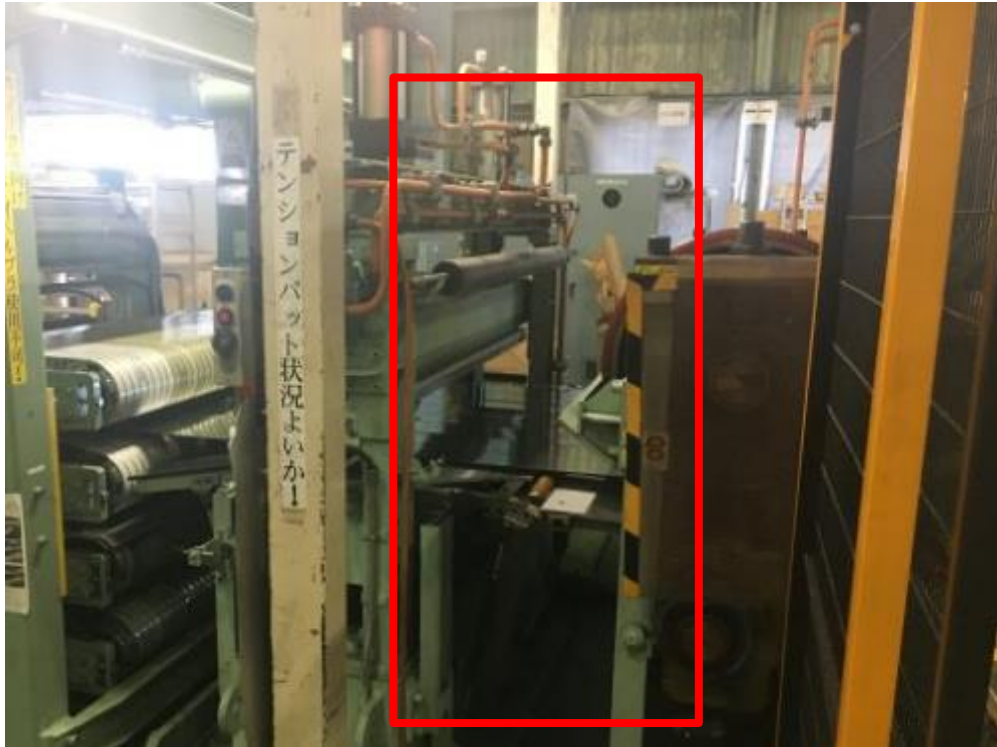
図 4.1.5-4) S2 の 8K ラインスキャンカメラや画像処理照明の設置値
