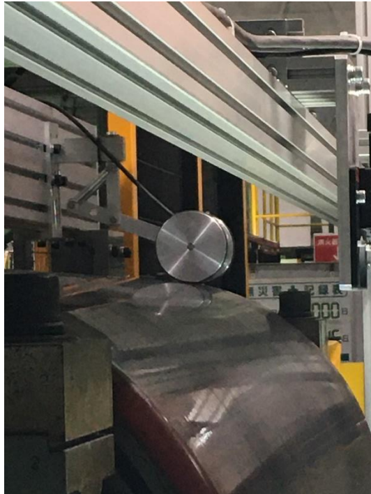
図 4.1.3-12) エンコーダー設置箇所 (エクステンションロールと接地させる)
