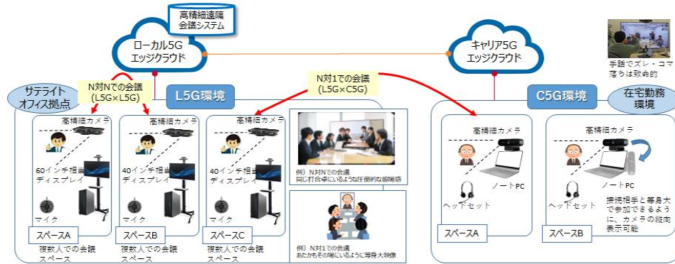
図1-2 高精細遠隔会議システムの構成概要
