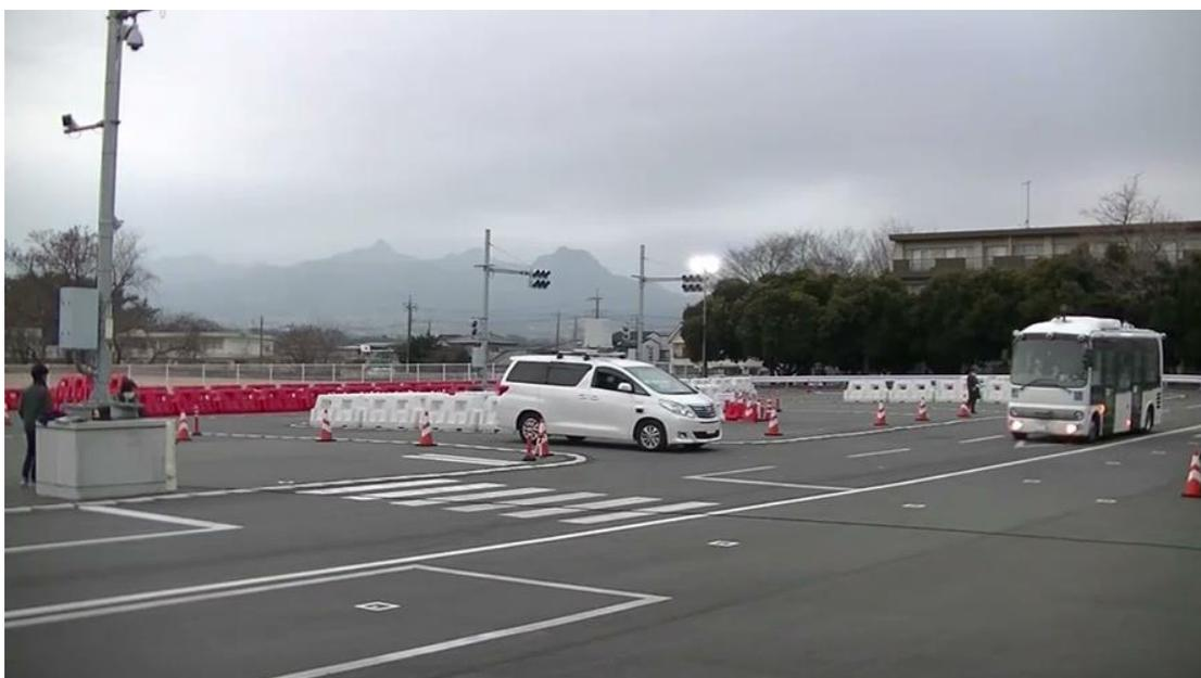
図 4.5.4-2 衝突回避模擬実験の様子
