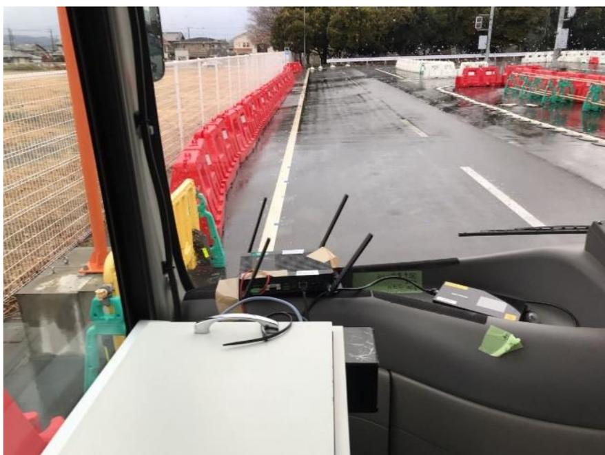
図 5.3.3-17 車両内 伝送スループット・伝送遅延時間測定方法 (DTU：1台接続)
