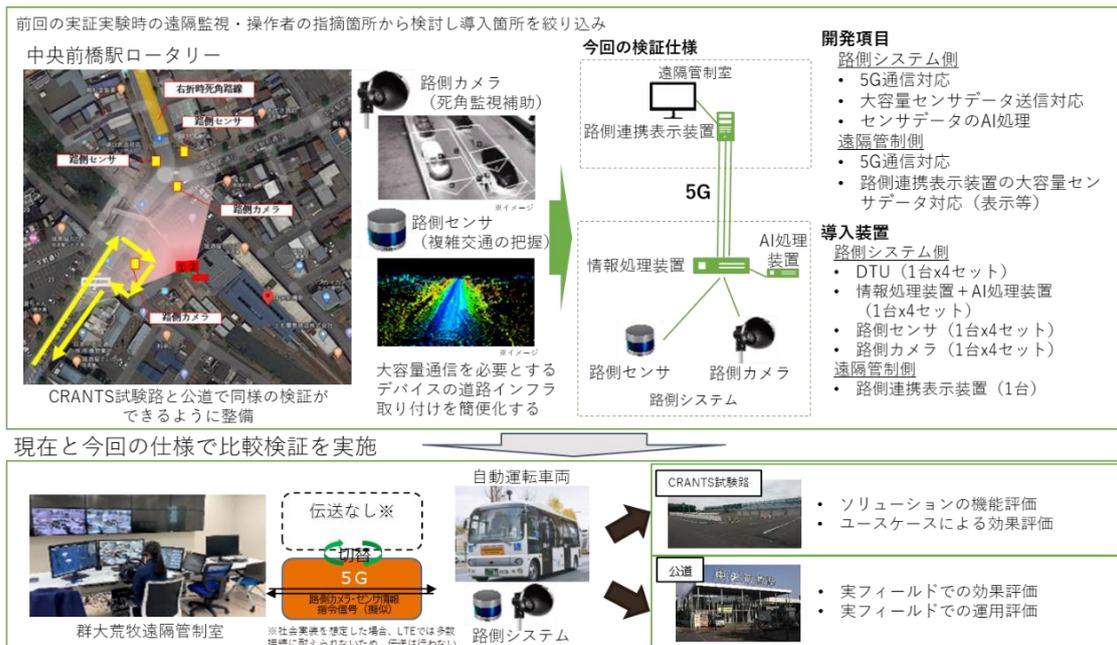
図 4.4.2-1 路車間協調通信① (5G 対応型遠隔管制室情報集約ソリューション (路側-遠隔管制室間)) 概要
