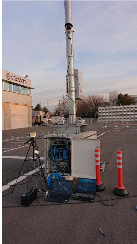
図 4.5.1-2 実験で用いた路側デバイス
