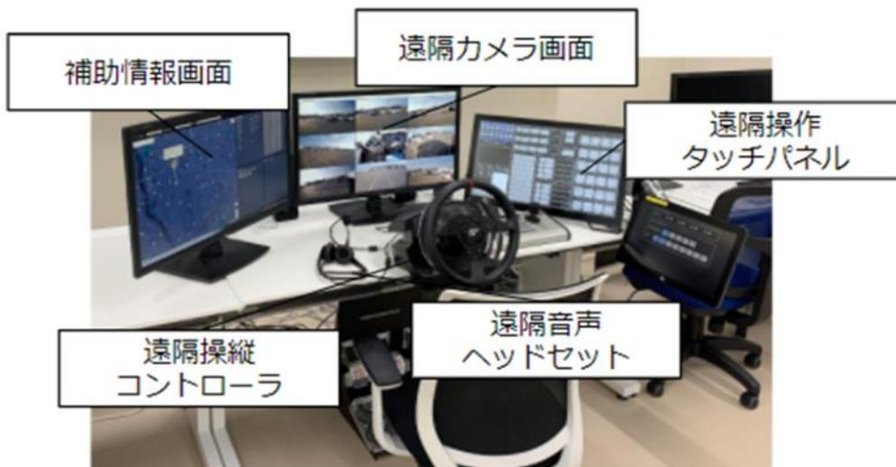
図 6.3.1-2 遠隔管制室の標準的設備
