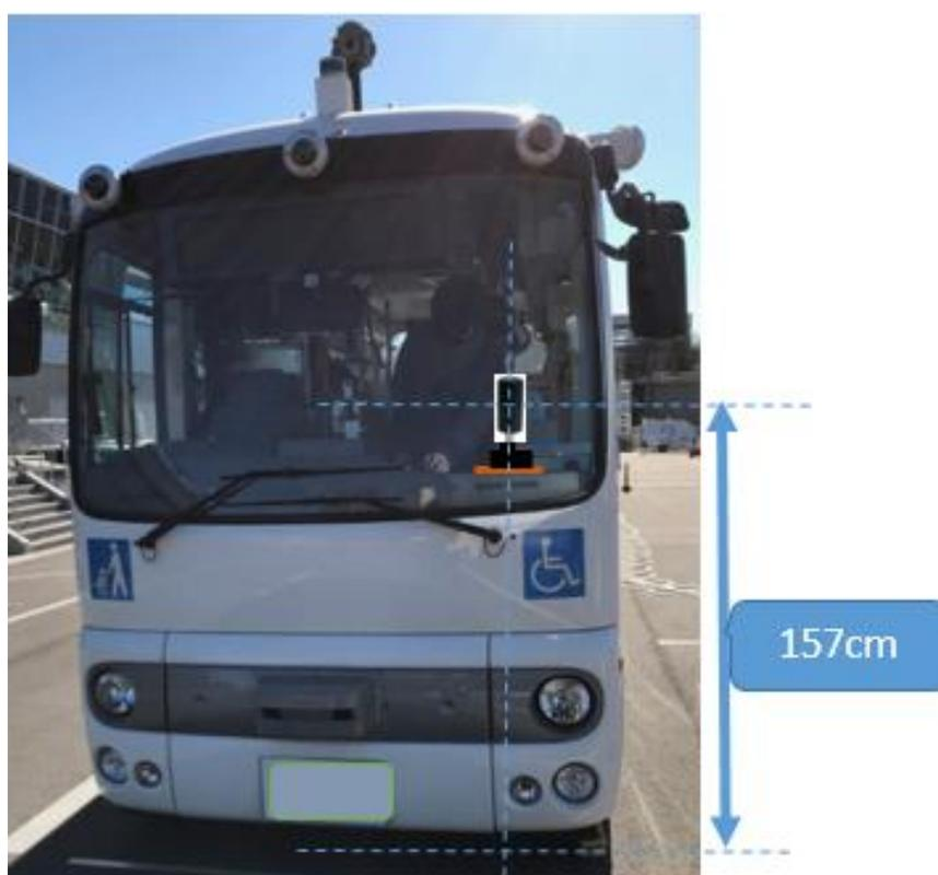
図 5.2.5-10 測定アンテナの高さ（車両）
