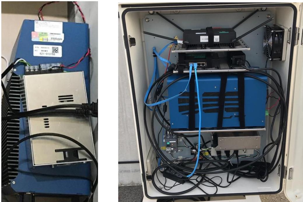
図 3.1.3-4 NEC AI 処理装置 (MEC サーバ(左)、AI 処理装置(右))
