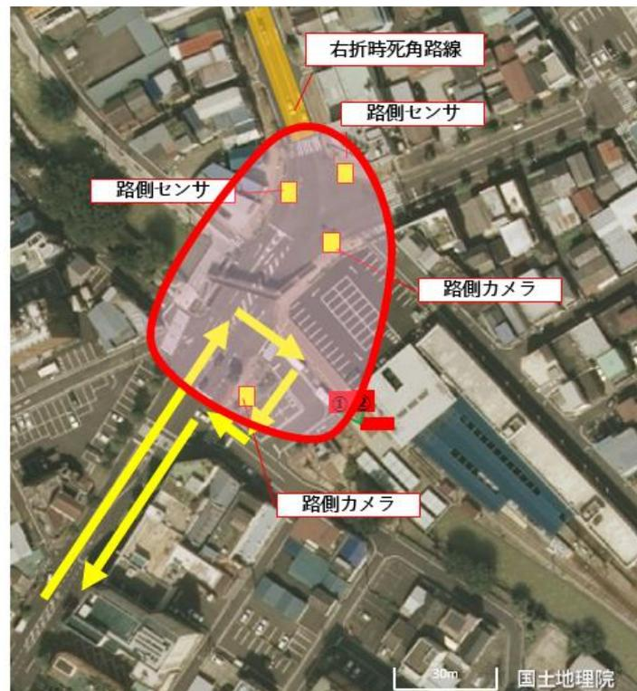
図 3.1.2-2 上毛電鉄中央前橋駅 エリアカバレッジ
