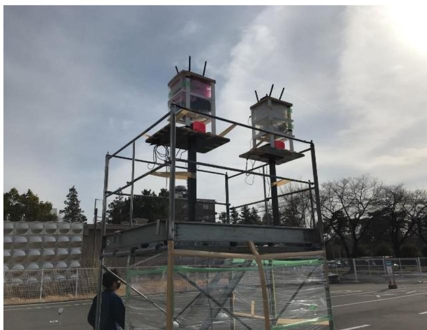
図 5.3.3-23 路側高所伝送スループット・伝送遅延時間測定方法 (DTU：複数接続)
