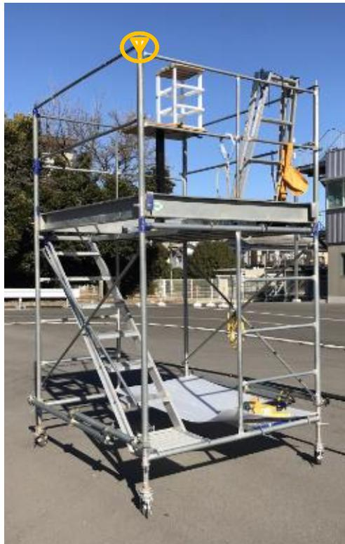
図 5.2.5-9 使用した車両等（ローリングタワー（路側高所測定台））
