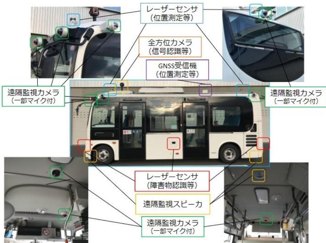
図 4.6.1-1 実験車両構成図
