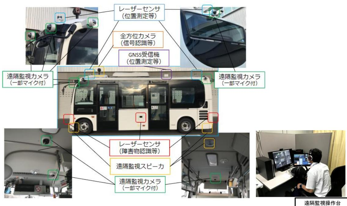
図 3.2.3-1 遠隔型自動運転システムの概要図
