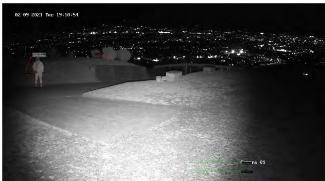
図 4-76 カメラ 2 (駐車場) 15m (赤外線照射装置による照射)
