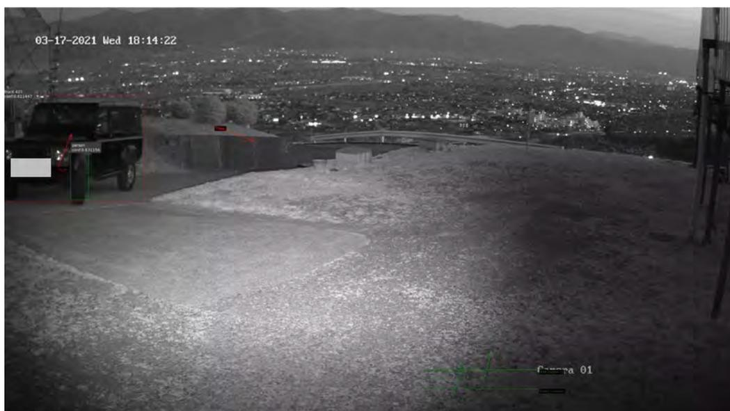
図 4-96 カメラ 2 (駐車場) 8m ライトなし、赤外線照射装置による照射
