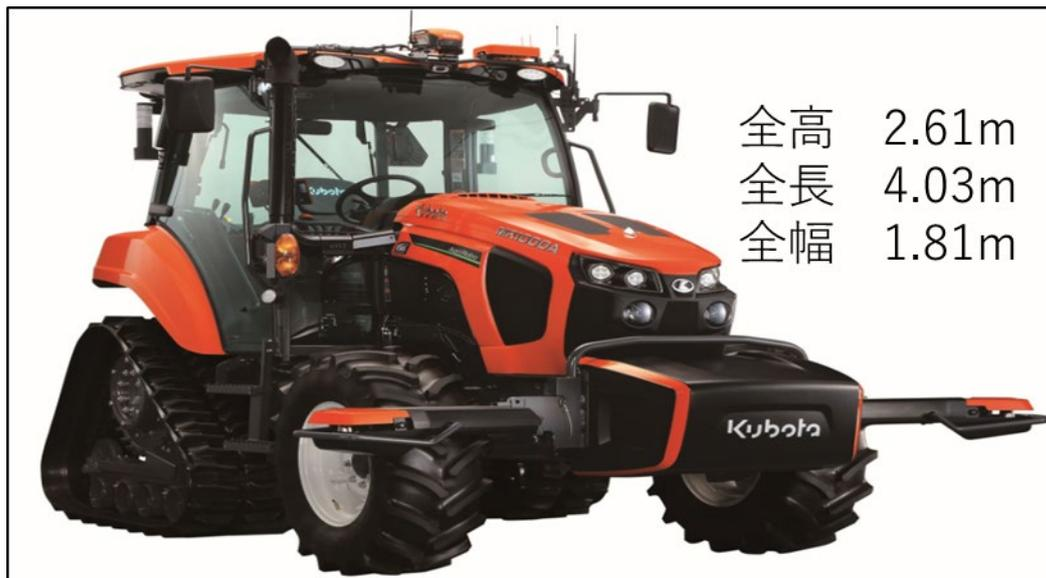
図 5.3.43 遮蔽物トラクター外観および寸法
