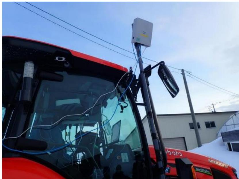
図 5.3.45 ローカル 5G 端末のトラクター上部への設置風景
