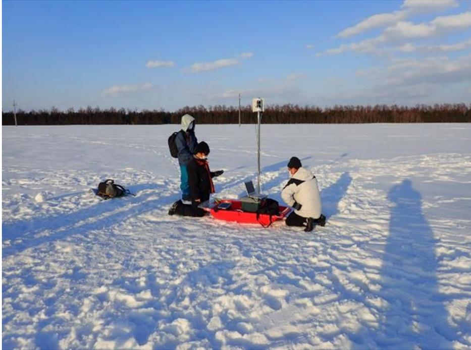
図 5.5.7 ローカル 5G 間干渉 DU 比 10 dB程度地点 測定風景
