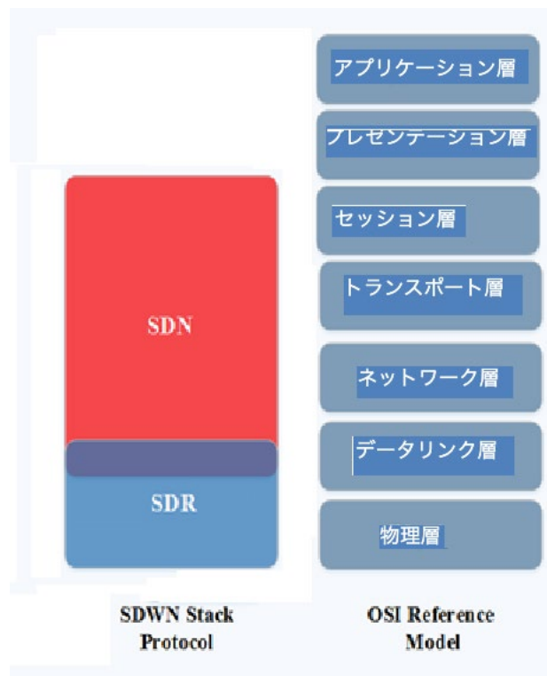
図表 6-30 OSI 参照モデルと 5G-SDWN のプロトコルとの比較
