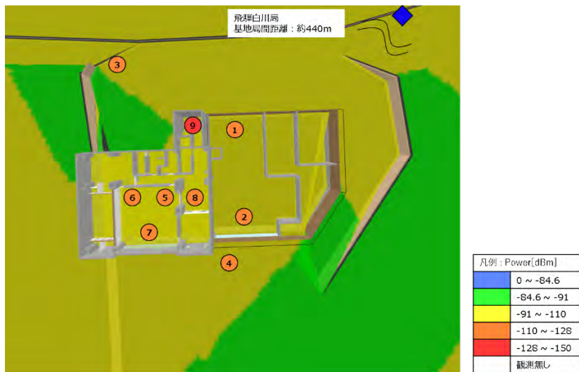
図 5. 4. 3-10 JA オフィス屋内エリア設計図と実測値との比較
