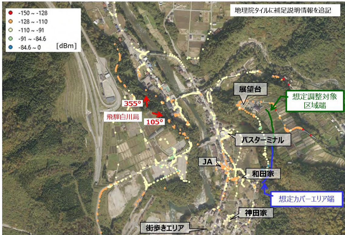
(b) 下り受信電力実測値からの屋外エリア推定図 図 5. 4. 3-6 飛騨白川局によるエリア形成評価
