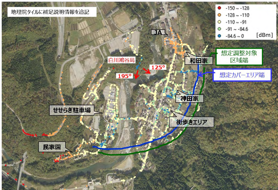
(b) 下り受信電力実測値からの屋外エリア推定図
