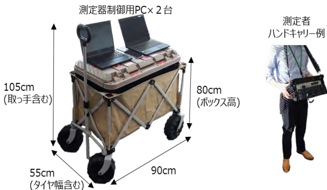
図 5.3.3-6 実測に用いた測定補助用治具
